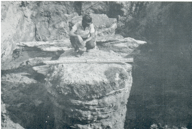
Figura 8.29 – medição de uma coluna injetada. (NOVATECNA Consolidações e Construções S.A.)
